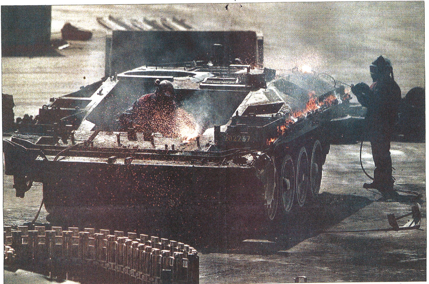
SVÅRSMÄLT FIASKO. Far och son från Helsingborg, Bengt och Johan Nilsson, skär ner stridsvagnarnas 40 millimeter tjocka pansarskal i lagom bitar för nersmältning.
