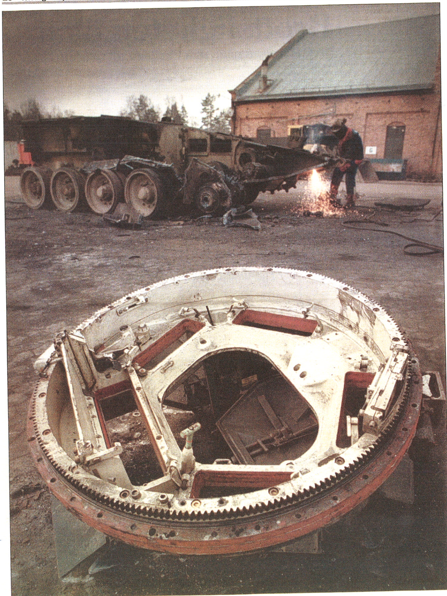
Skärbrännaren gör sitt och den 35 ton tunga stridsvagnen delas i "småbitar" för att passa Avesta järnverks smältugnar.
