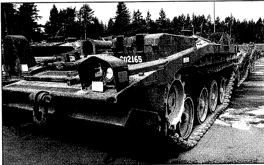
Stridsvagn 103 (strv 103), Sverige 1963, Förserievagn. I serien modifierade motorer. Även benämnd "stridsvagn S". 36 ton, 3 man, 10.5 cm automatladdad kanon, 3 ksp, 540 hk på två motorer. 50 km/tim.
