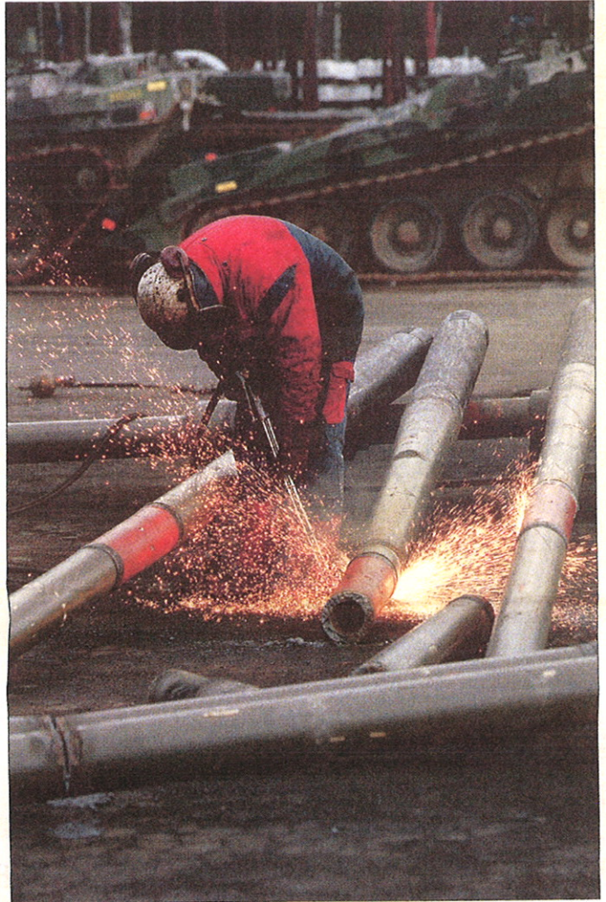
Johan Nilsson och de andra tretton anställda på återvinningsföretaget Stena Gotthard i Vislanda har att göra de närmaste två åren. 7 740 000 kilo stridsvagn S ska bli småskrot. Eftersom pansarplåten är hård måste de 215 stridsvagnarna skäras i bitar för hand.
